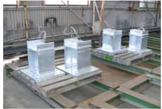
写真-3 制震ストッパーの製作状況(山下垣花高架橋)
