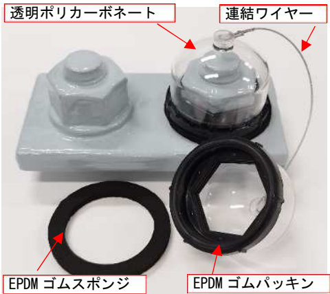
図 1 ボルトキャップの概要
