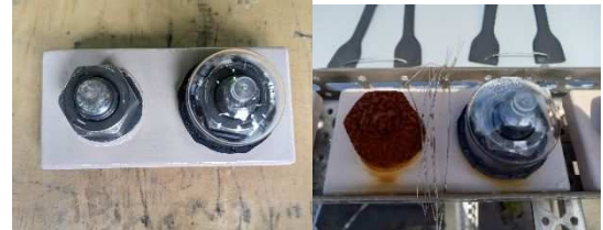
(a)試験開始時 (b)1年経過時 図-7 ケース4の暴露状況
