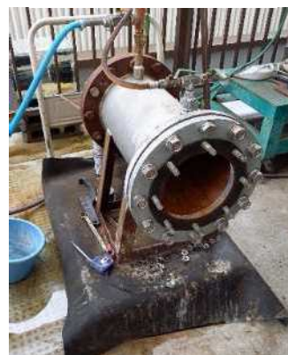
図3 防浸性試験状況
