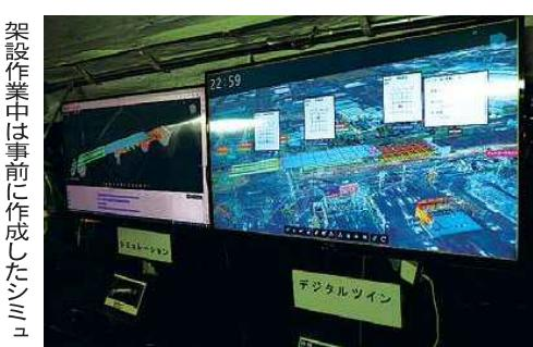
架設作業中は事前に作成したシミュレーションとリアルタイムで比較しながら工程管理に当たった。「作業員への情報伝達が容易となり施工性が向上している」（塙本現場代理人）と手応えを語る。
